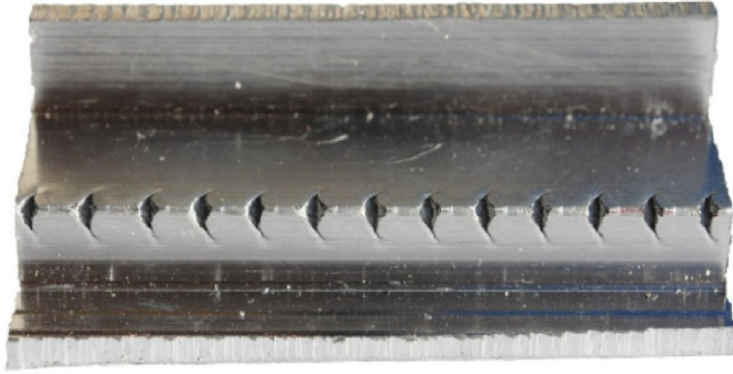
Edge cracks in an Al 6060 extruded profile (Bernard, 2018).
